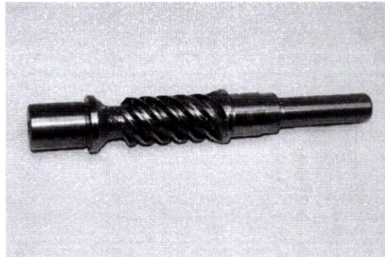
Figura 19: Eixo (Haste) sem fim do redutor e válvulas.
